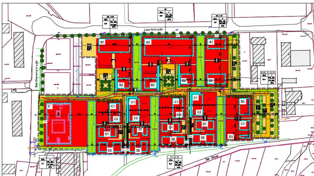
Abbildung 21: Begleitender Lageplan der festgesetzten Baufelder zur Erläuterung (Auszug aus Planzeichnung)
